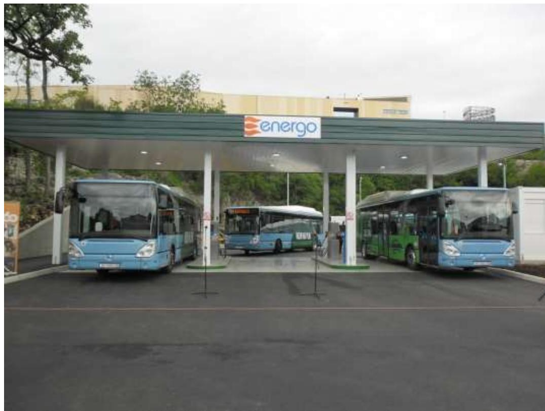
prva tzv. **fast fill** punionica u RH – osobni automobil spremnik goriva napuni za 3-5 min, autobus i komunalna vozila za 10 min
